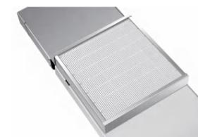
Опциональная высокоэффективная система фильтрации HEPA в сочетании с уникальной конструкцией воздуховодов для циркуляции воздуха позволяет непрерывно фильтровать загрязняющие вещества (биологические загрязнители и взвешенные частицы) в шкафу, гарантируя, что инкубатор сможет достичь чистоты помещения класса ISO 5 в течение 5 минут после закрытия внешней двери, что соответствует классу 100 стандарта 209 E Соединенных Штатов
