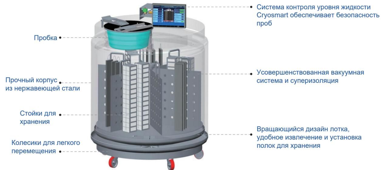
Уникальная конструкция уменьшает количество конденсации водяного пара на внешней поверхности горлышка, а контейнер усилен при температуре жидкого азота, чтобы продлить физический срок службы контейнера.
