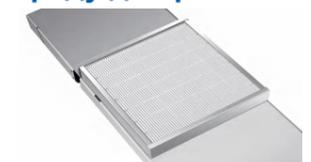
Дополнительная высокоэффективная система фильтрации HEPA вместе с уникальной конструкцией циркуляционного воздухопровода позволяет непрерывно фильтровать загрязняющие вещества (биологические загрязнители и взвешенные частицы) в шкафу, гарантируя, что инкубатор достигнет класса 5 чистого помещения по ISO в течение 5 минут после закрытия внешней двери, что соответствует классу 100 стандарта 209 E США.
