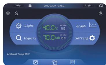
•Интеллектуальный контроллер с 10-дюймовым сенсорным экраном прост в управлении и чувствителен к прикосновениям даже в резиновых перчатках Алгоритм ПИД-регулирования обеспечивает точное управление температурой
