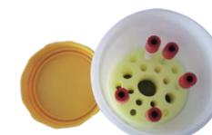
**Герметичные канистры (держатели EPS или EPE для хранения пробирок, пробирок с 16 отверстиями D10 и пробирок с 2 отверстиями D15)**
